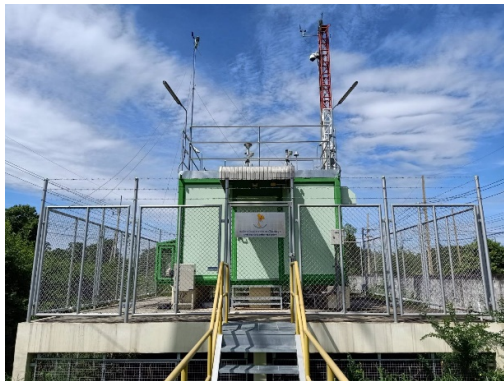
(ข) สถานีตรวจวัดคุณภาพอากาศ AAQMS 002 ด้านหลังโรงไฟฟ้าขนาดเล็ก
